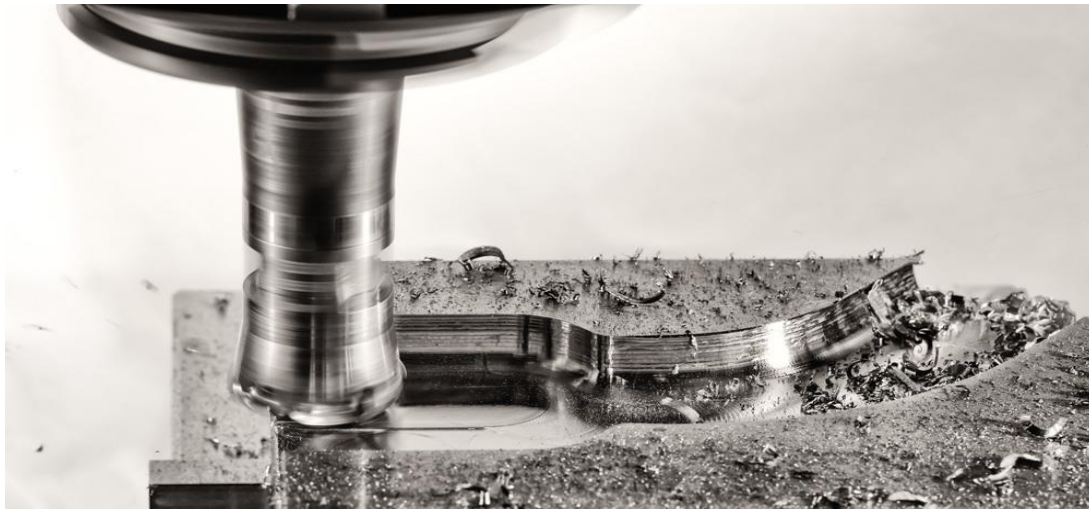
Figure7 : processus de fraisage
