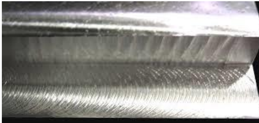
Figure 14: l'effet des vibrations sure une pièce usinée
