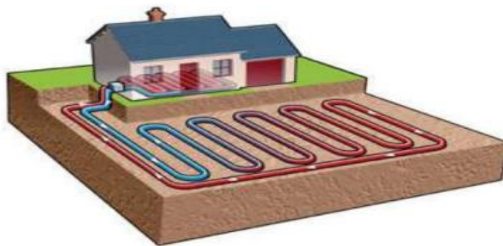
Figure III.20 : Echangeur horizontale enterré [23].
