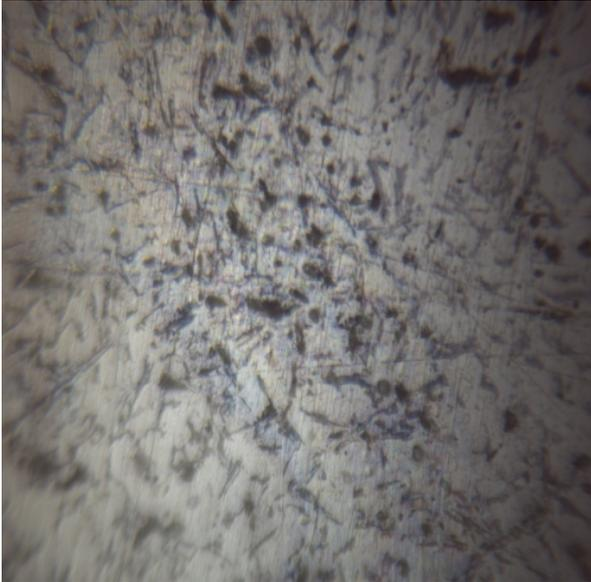
**Figure 30 :** Microstructure de l'alliage S2 et S1 avant traitement thermique
