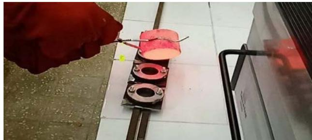
**Figure 23:** creuset en graphite et moule a Cylindre ouvert en acier
