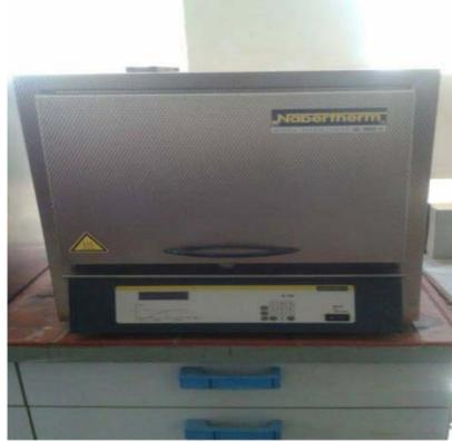
**Figure 22 :** Le four utilisé pour le traitement de mise en solution
