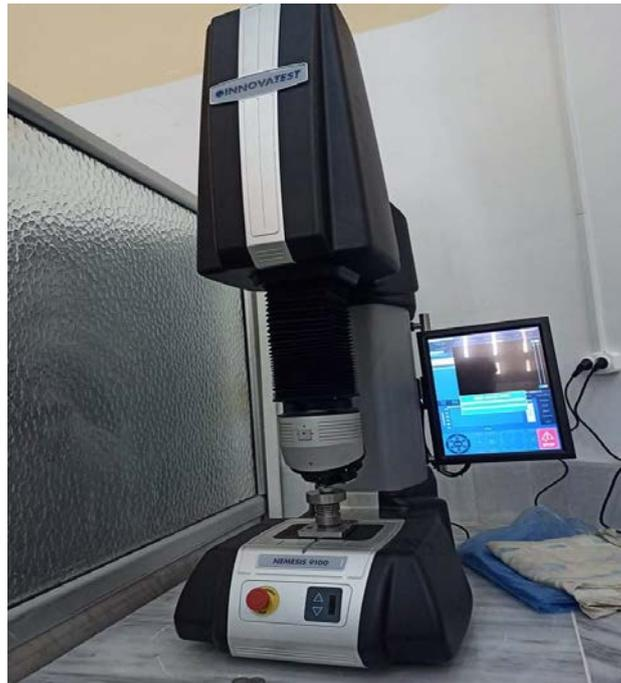
**Figure 29** : Duromètre
