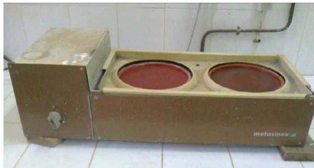
**Figure 25 :** Appareil de polissage de finition
