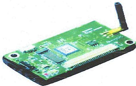
Figure 1.1.Exemple d'un Capteur MICAz. [2]
