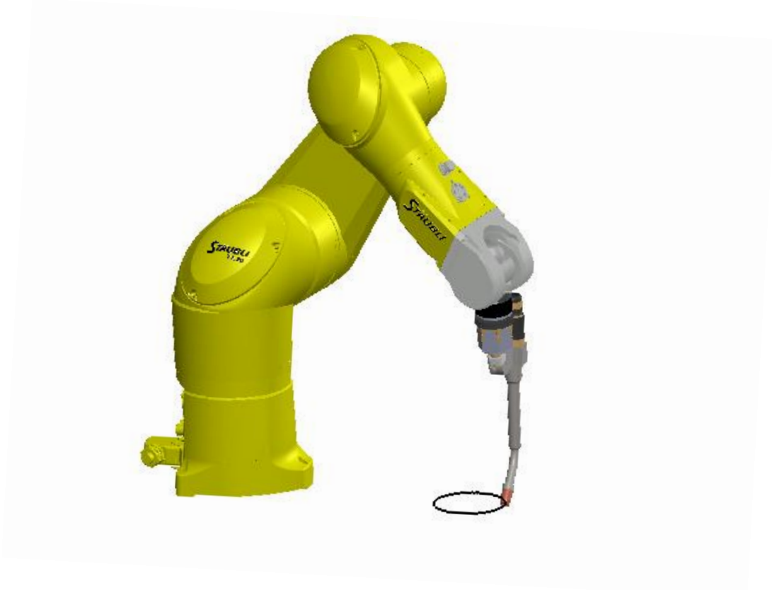
Figure 3.2 : Trajectoire de soudage programmer
