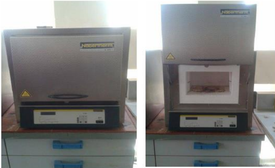
Figure (18) : Le four utilisé pour le traitement thermique NABERTHERM.
