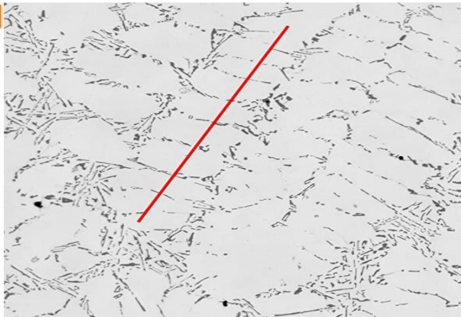
Figure (2) : Micrographie optique illustrant la mesure des espacements des bras dendritiques secondaires (SDAS) [7]
