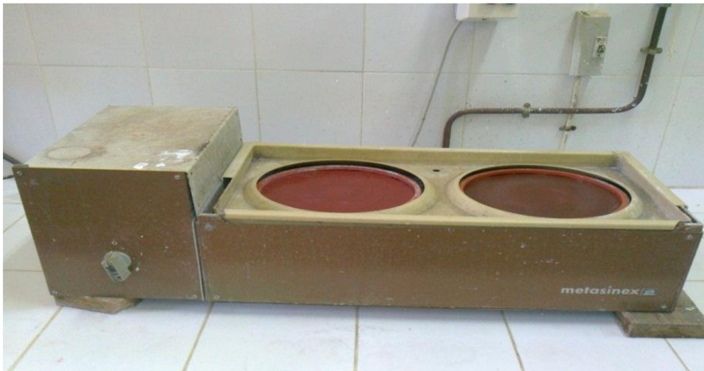
Figure (21) : Polisseuse d'abrasion.
