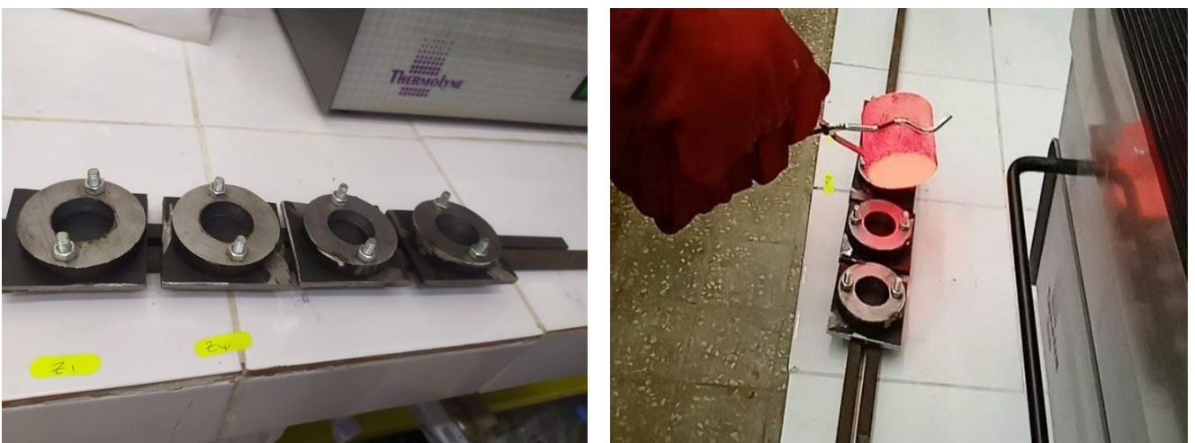
Figure (19) : le creuset en graphite utilisé et les moules a cylindre ouvert en acier.
