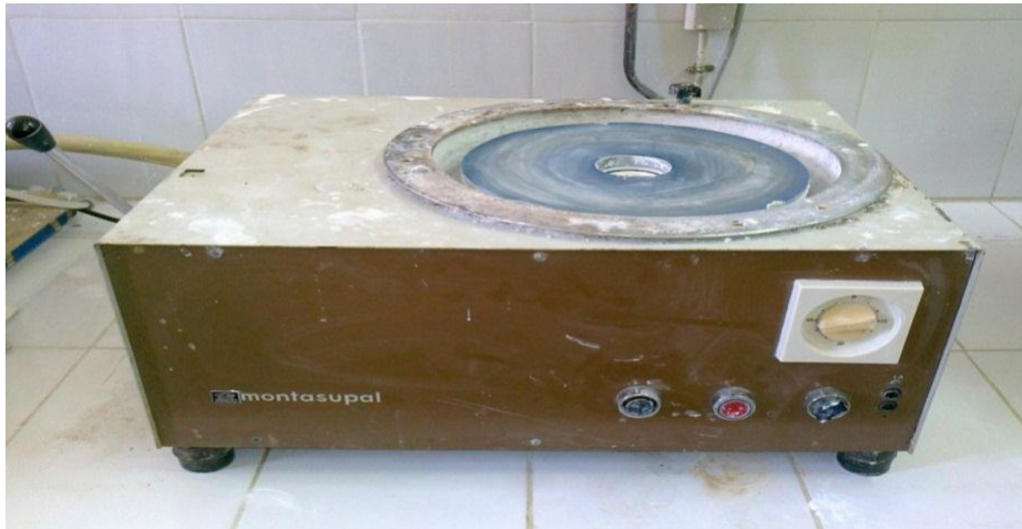
Figure (22) : polisseuse de finition.
