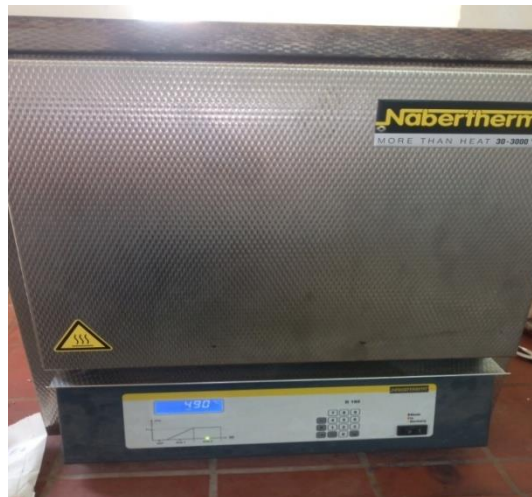
Figure (27) : Le four (NABERTHERM) en mise en solution.
