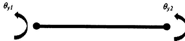
Fig. (2.3) Elément de poutre en torsion.
