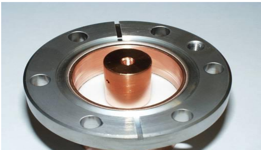
Figure I .12 . Brasure alumine / Cuivre (Passage HOM, Cavités 400 MHz).[11]
