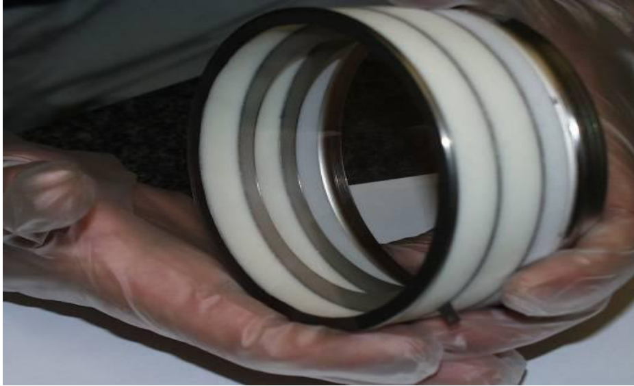
Figure I. 13 . Fenêtre Saphir, diamètre 114 mm sur Nb et anneaux d'alumine (Détecteur PET-HPT)[11]
