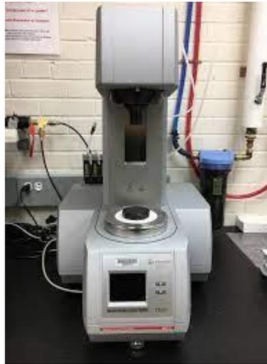
**Figure IV.3** Rhéomètre de type Anton Paar MCR 302.
