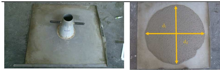
Figure 3.7 Essai d'étalement au cône d'Abrams.
