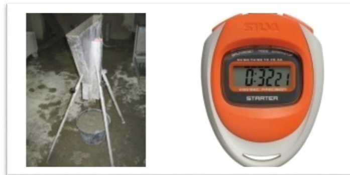
Figure 3.10 : appareillage de mesures du temps d'écoulement à l'entonnoir en V.
