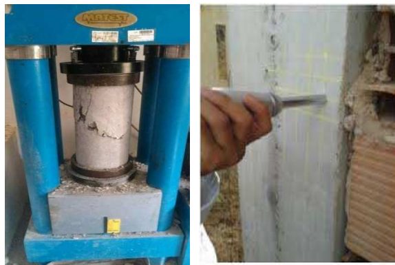
Figure 3.1 appareillages de la mesure la résistance à la compression du béton.
