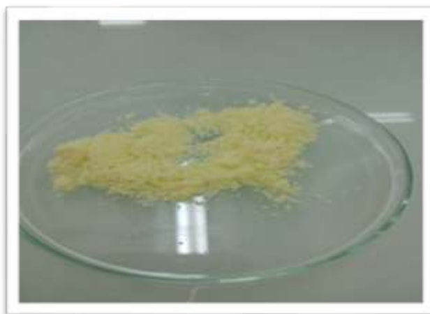
Figure 2.6 : la base de Schiff 1,3-bis (2-hydroxy benzylidène) thiourée.
