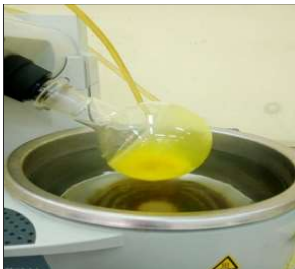
Figure 2.2 : Synthèse conventionnelle de 1,3-bis (2-hydroxy benzylidène) urée
