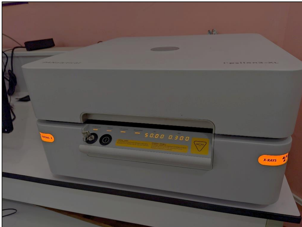
Figure 3.13 : Dispositif expérimentale de la (EDXRF)
