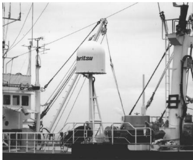
Figure 11 : Photographie de l'équipement au-dessus du pont (ADE) installé sur un navire. L'antenne est recouverte d'un radôme
