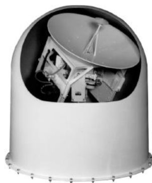
Figure 12 : Une antenne à l'intérieur d'un radôme
