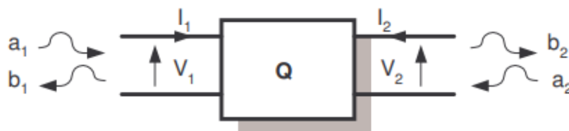
Figure 18 : Tensions et courants appliqués à un quadripôle
