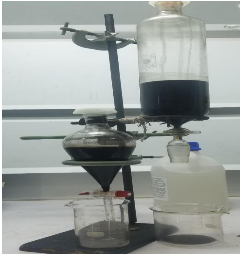
Figure 2.24 : Décantation après traitement par l'acide sulfurique
