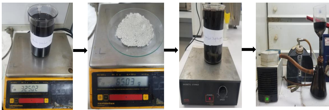
Figure 2.25 : Les  tapes de l'adsorption par la bentonite
