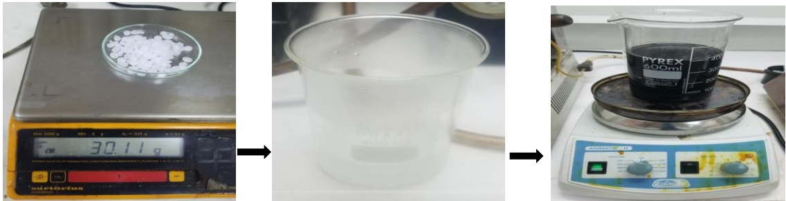
Figure 2.26 : Les étapes de traitement avec l'hydroxyde de sodium
