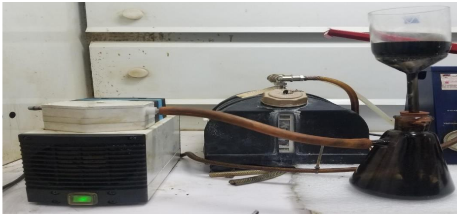
Figure 2.22 : Filtration sous vide d'huile usagée
