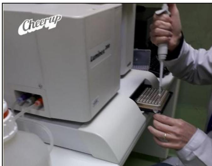
Figure 8.24: dépôts des microbilles au niveau des puits (photo personnelles).
