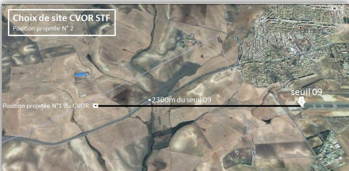
Figure III.4 : Position 2 à 2300m du seuil 09 [14]
