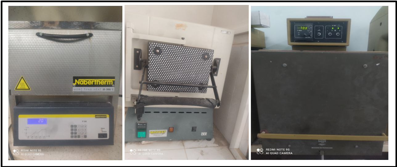
Figure III.4. Photo numérique montre les Four de calcination (Nabertherm 30-3000 °C), (matest), (MLM elktro).
