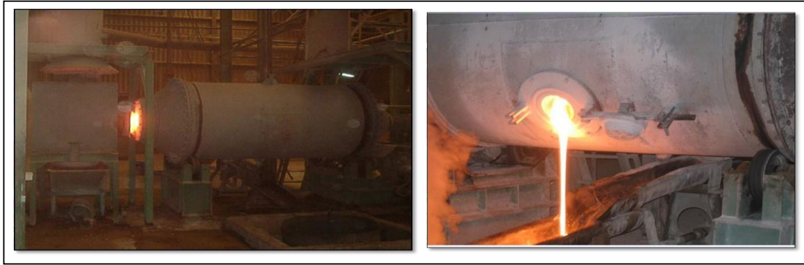
Figure II.7 : Photo numérique montrant le processus de fusion des frites.
