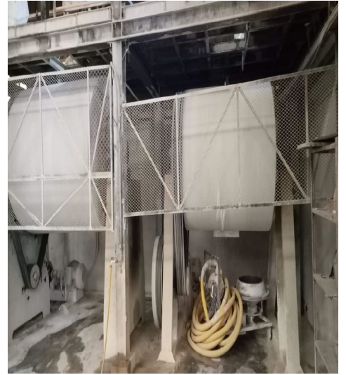
Figure II.3 : Photo numérique montrant les moulins à tambours
