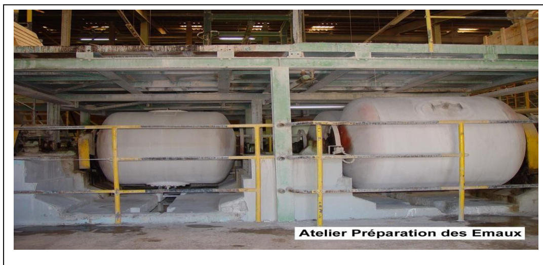
Figure II.8 : Photo numérique montrant les moulins à tambour pour la préparation de l'email et l'engobe.
