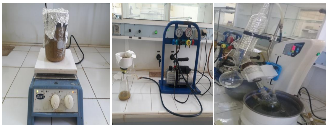
Figure IV .3 : Dispositif d'extraction par macération
