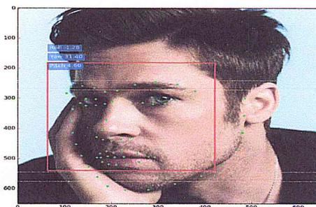
Fig. V.4 Détection et localisation des points de repères faciaux dans une image avec un visage de profil avec la méthode VGGNet
