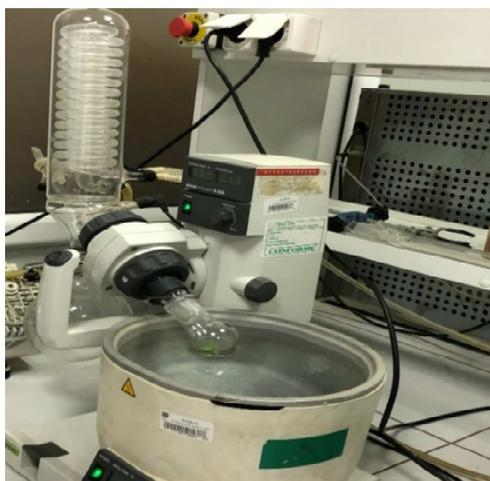
**Figure 3.1 :** Montage expérimental utilisé pour la formulation de la dispersion solide.
