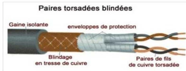
Figure I.12 : Paire torsadée blindée (STP).
