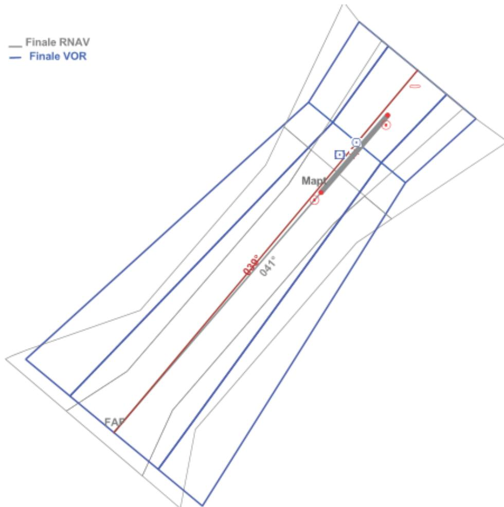
**Figure (II-8)** Superposition des aires RNAV / Conventionnelles
