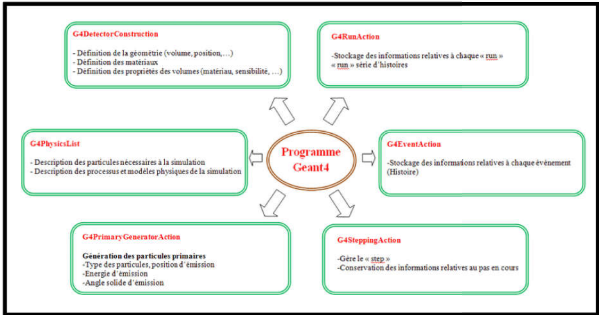
Figure II. 7: Architecture minimale d'un code de simulation dans GEANT4 [Thiam, 2007].
