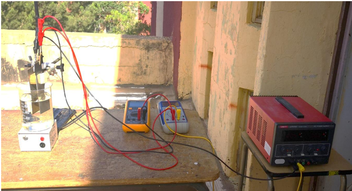
Figure III- 2 : Dispositif expérimental du procédé photo-électro-Fenton-solaire
