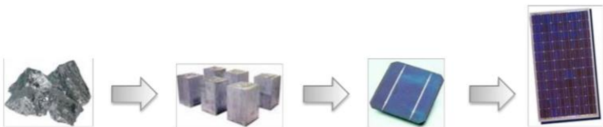
Figure I- 1: La fabrication des plaques, cellules et modules photovoltaïques [9]
