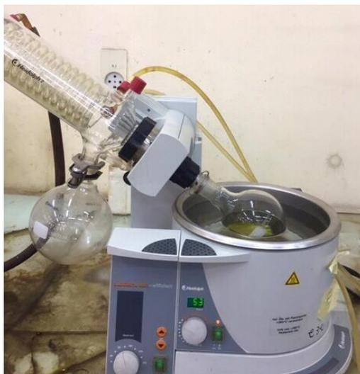
**Figure III.3.** Elimination du solvant « éther de pétrole » par le rotavapeur
