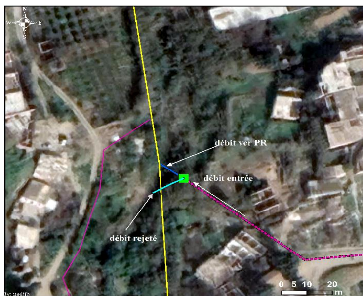
Figure 8.4 : Déversoir d'orage N 2 (basin E)
