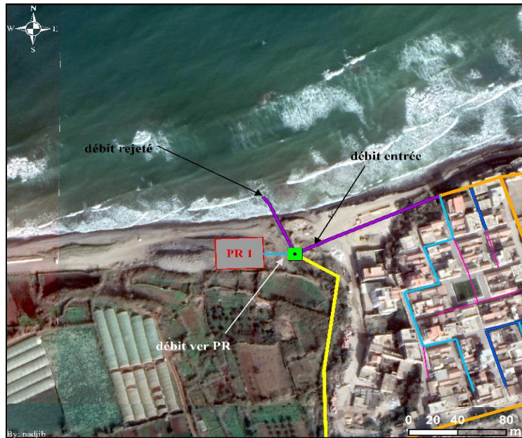
Figure 8.6 : Déversoir d'orage N 4 avant PR 1.
