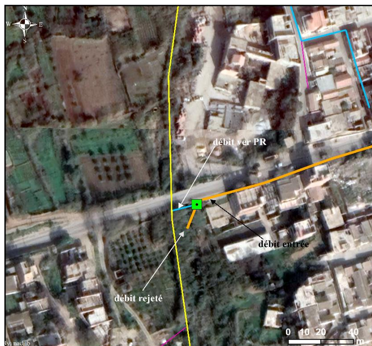
Figure 8.5 : Déversoir d'orage N 3 (basin C)
