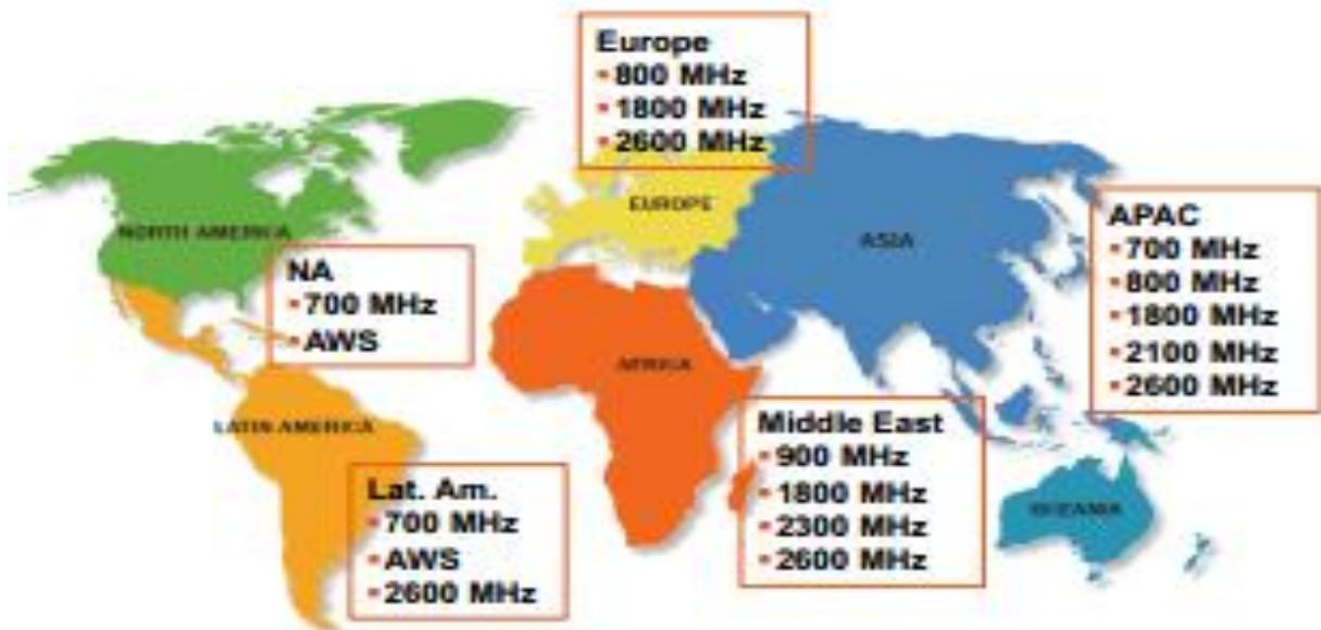
**Figures 1.6 :** Bandes de fréquences allouées à la norme LTE
