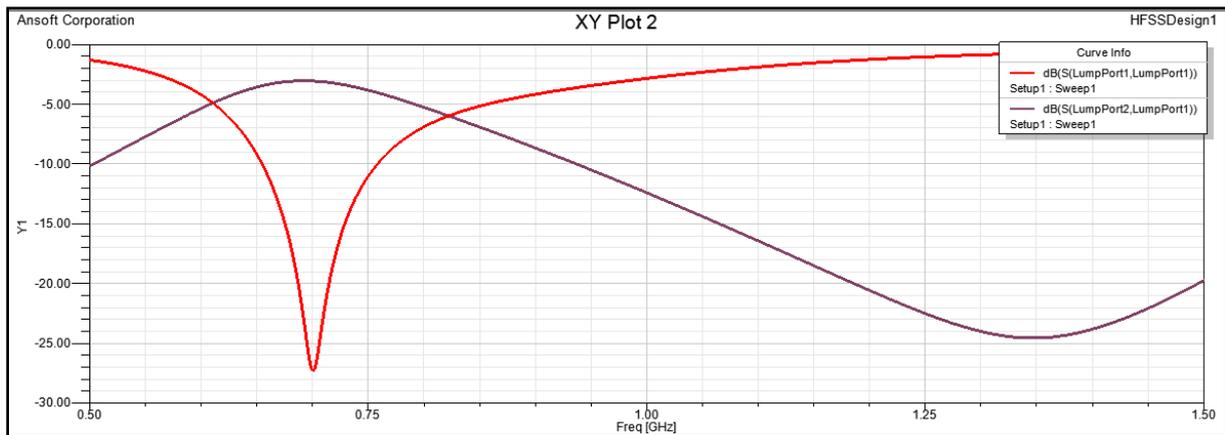
**Figure 3.15 :** Coefficient de réflexion  $|S_{11}|$  et coefficient de transmission  $|S_{21}|$  d'une antenne MIMO compacte pour l'application LTE 700
