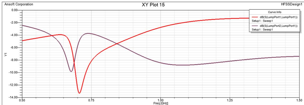
**Figure 3.17 :** Coefficient de réflexion  $|S_{11}|$  et Coefficient de transmission  $|S_{21}|$  d'une antenne MIMO à base de la géométrie 2 avec la ligne de neutralisation
