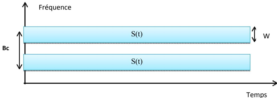
**Figure 1.9** : Le même signal est transmis sur plusieurs intervalles fréquentiels.
