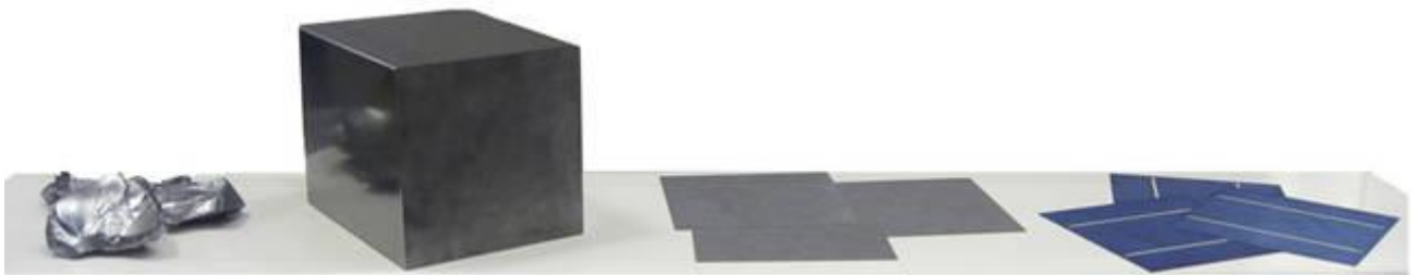
Figure I. 1 du silicium à la cellule PV.
