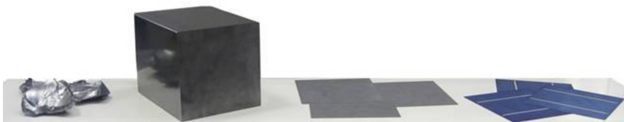
Figure I. 1 du silicium à la cellule PV.
