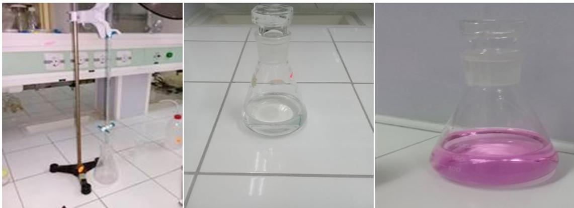
**Figure 10** :a) Solution avant dosage b) solution après le dosage.
