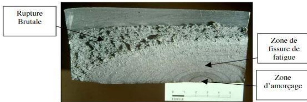
Fig. II .1 : Faciès de rupture
