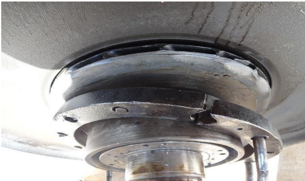
Fig. II . 8 : Déformation au niveau de la bague de fixation
