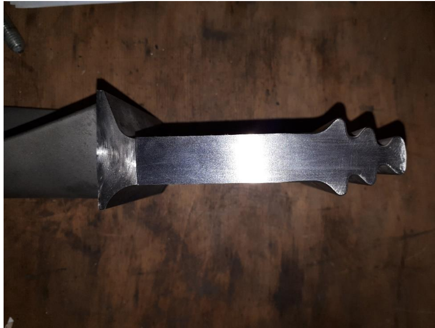
Figure 4.18: Aube basse pression après traitement
