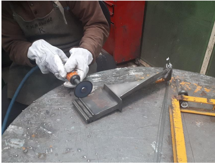
Figure 4.26: découpage de la partie rechargée
