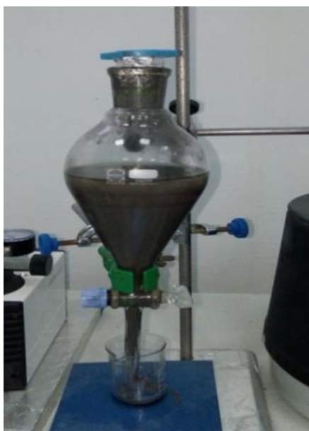
Figure 4.14: Extraction liquide- liquide dans une ampoule à décanter
