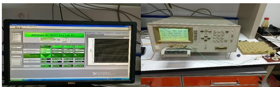
**Figure 4.9:** Impédance metre de type Agilent 4284A.
