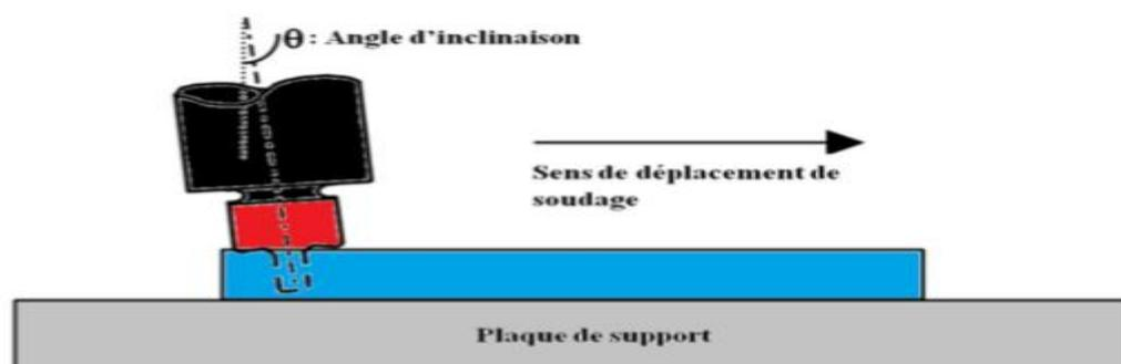
**Figure 1.11:** l'angle d'inclinaison d l'outil [4].
