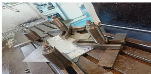
**Figure 4.2** : la fixation des plaques à souder.
