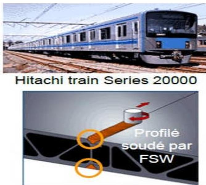
Figure 1.23 : soudage de profilé du train Hitachi [1].
