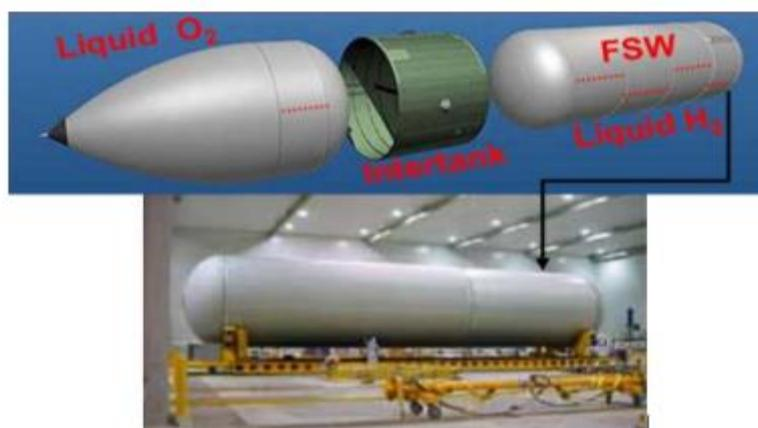
**Figure 1.20:** Utilisation du procédé FSW pour souder les réservoirs de carburant de ses fusées Delta par la compagnie Boeing [6].
