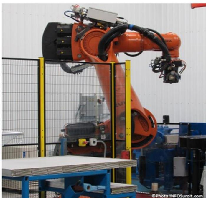
**Figure 1.2** : Robot asservi pour le FSW doté de sa tête de soudage.
