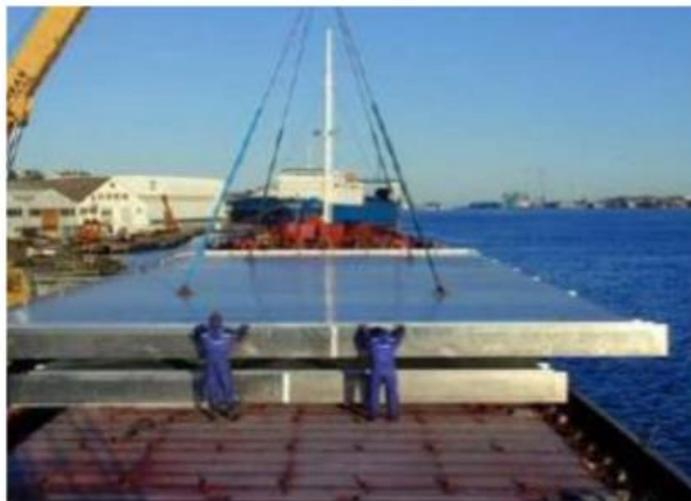
**Figure 1.21 :** Panneaux préfabriqués (Hydro Marine Aluminium) destinés au pont du bateau de croisière "The World" [1].
