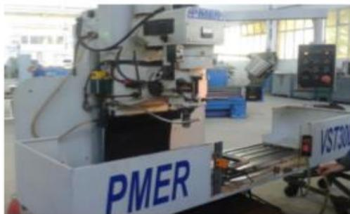
**Figure 4.1** : Fraiseuse utilisée pour FSW.
