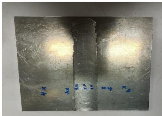
**Figure 4.11 :** Les points à contrôler.
