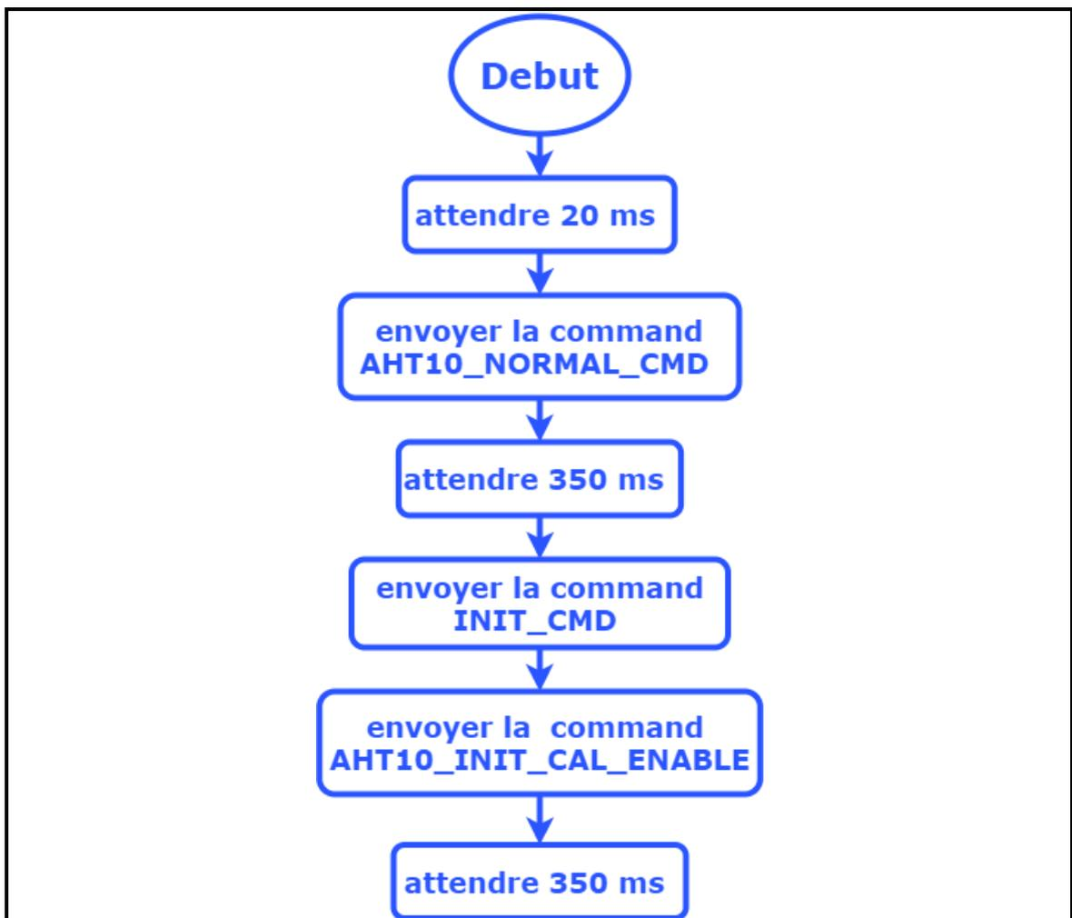
**Figure 2.70 :** Initialisation du capteur
