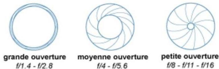
**Figure I.7:** Les types d'ouverture des objectifs.
