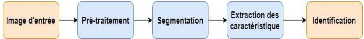
**Figure III.18:** Schéma bloc des étapes du traitement d'une image.
