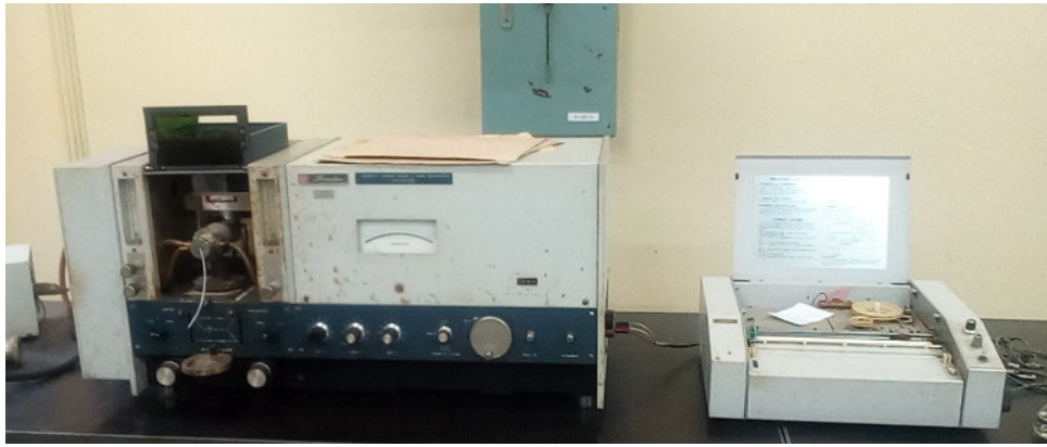
Figure IV.13 : Le dispositif utilisé à la spectrométrie par absorption atomique – émission de flamme.
