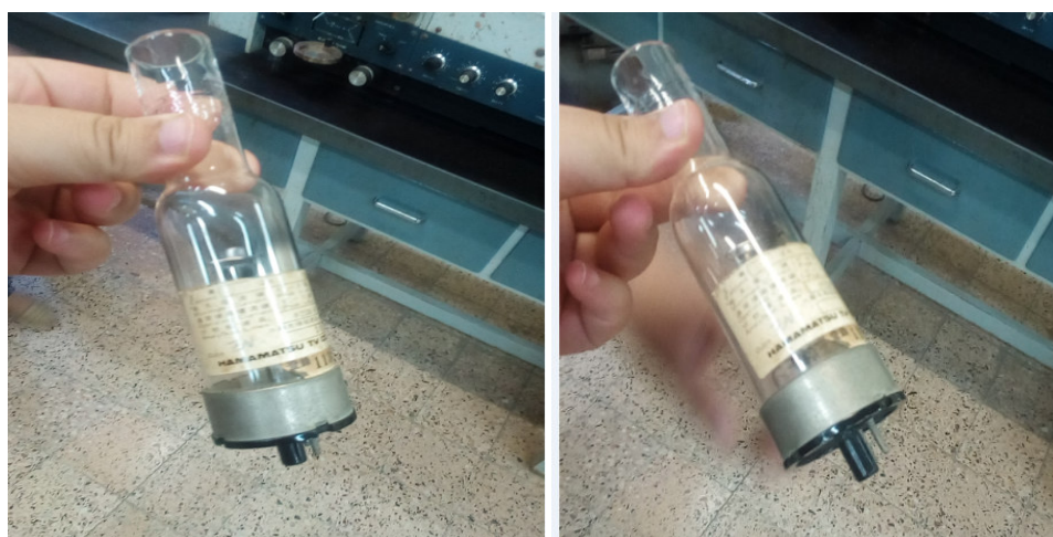
Figure IV.12 : La lampe à cathode creuse.
