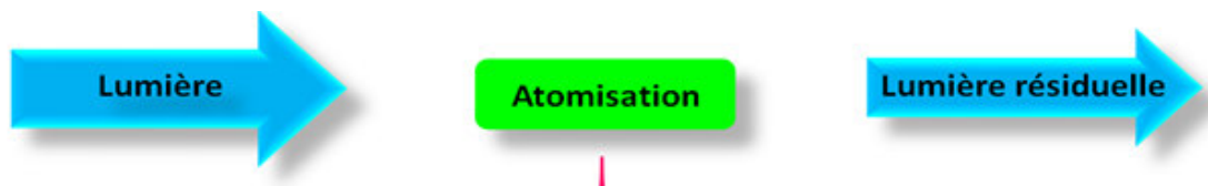
Figure II.4 : Principe de l'absorption atomique.
