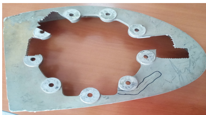
Figure IV.2 : Le couple N=°6 de la poutre de queue de l'hélicoptère Mi-24.
