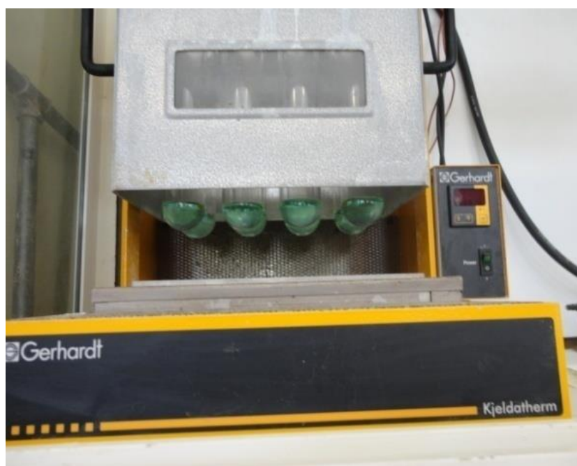
Fig.7.15 : Appareil de minéralisation (ITAF)
