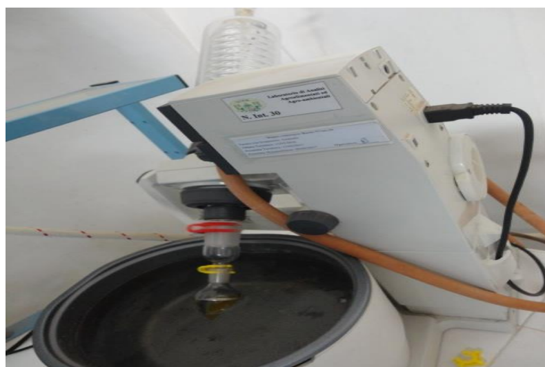
Fig.7.25 : Rota vapeur pour purification de la solution (CRSFA, Italie)
