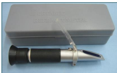
Fig.7.12 : Appareil de mesure du Brix « le refractomètre »
