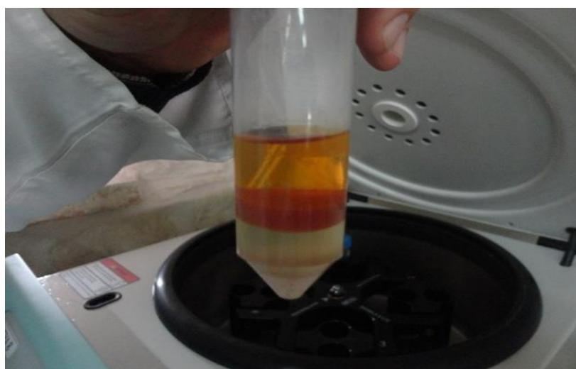
Fig.7.23 : Phase organique après centrifugation de la solution (CRSFA, Italie)
