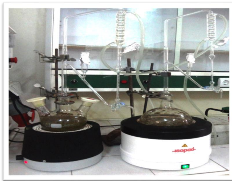
Figure 2.5 : Montage de l'hydrodistillation type Clevenger.
