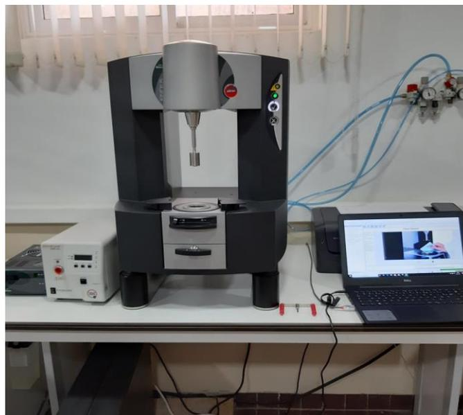
**Figure II.4.**Rhéomètre de Malvern Bohlin (Kinexus ultra plus) utilisé pour les mesures de viscosité
