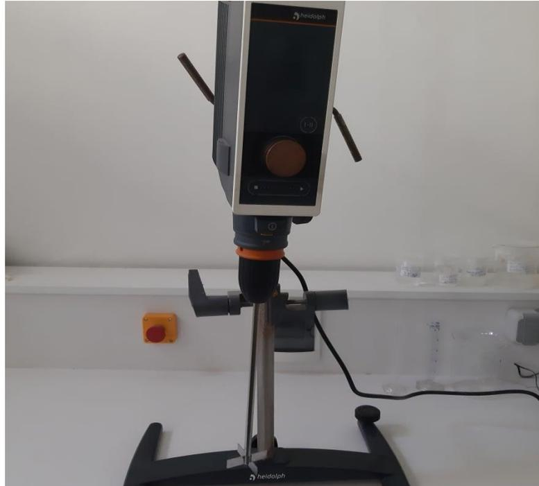
**Figure II.3.**Mélangeur à palette (Heidolph, model RZR2041)
