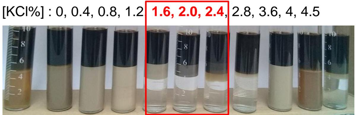
**Figure III.13.** Effet de la concentration de KCl sur le comportement de phase du système ASP-5100/Eau/Huile
