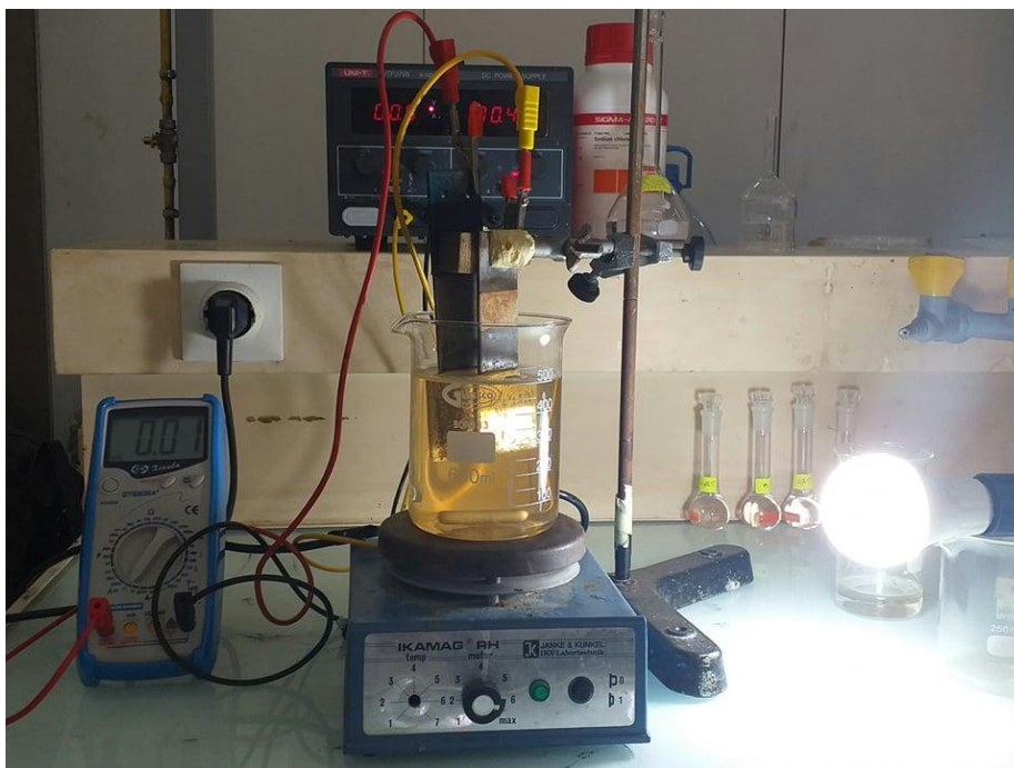
Figure III.9 : Dispositif expérimental du procédé photo-électro-fenton.
