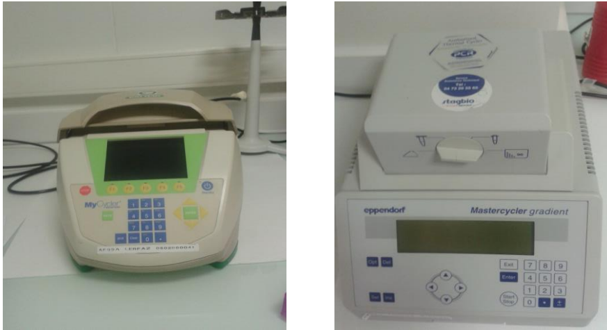
Figure 8.8 : Thermocycleurs utilisés pour la réaction d'amplification d'ADN lors des techniques MLVA et MLST. (Photo à gauche) Thermocycleur Bio-Rad MyCycler, (Photo à droite) Thermocycleur Eppendorf MasterCycler gradient (Photographie personnelle)
