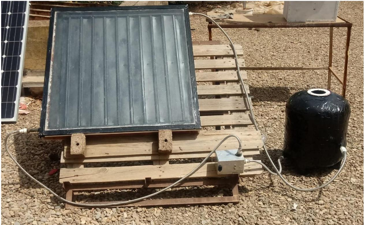
**Figure 2.18.** *L'assemblage des composants de système de chauffe-eau solaire*
