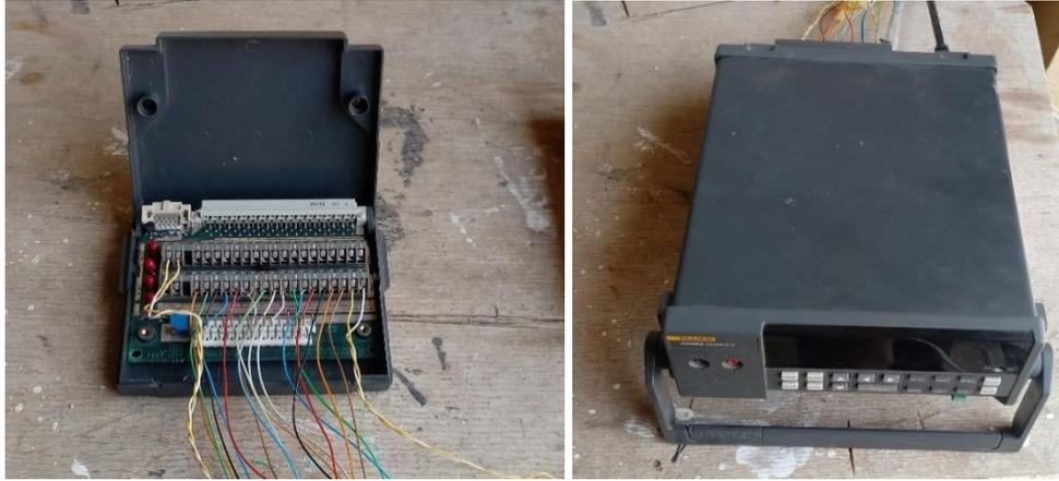
**Figure 3.4** Les fils de compensation liés à l'acquisition de données
