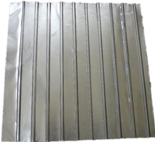
**Figure 2.7.** *L'absorbeur ondulé en aluminium*
