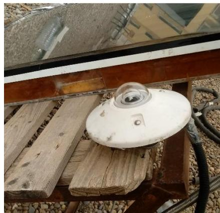
**Figure 3.3** La position du pyranomètre dans le système expérimentale
