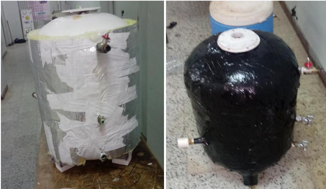
**Figure 2.14.** La cuve de stockage après l'isolation par la laine de roche de 5 cm d'épaisseur
