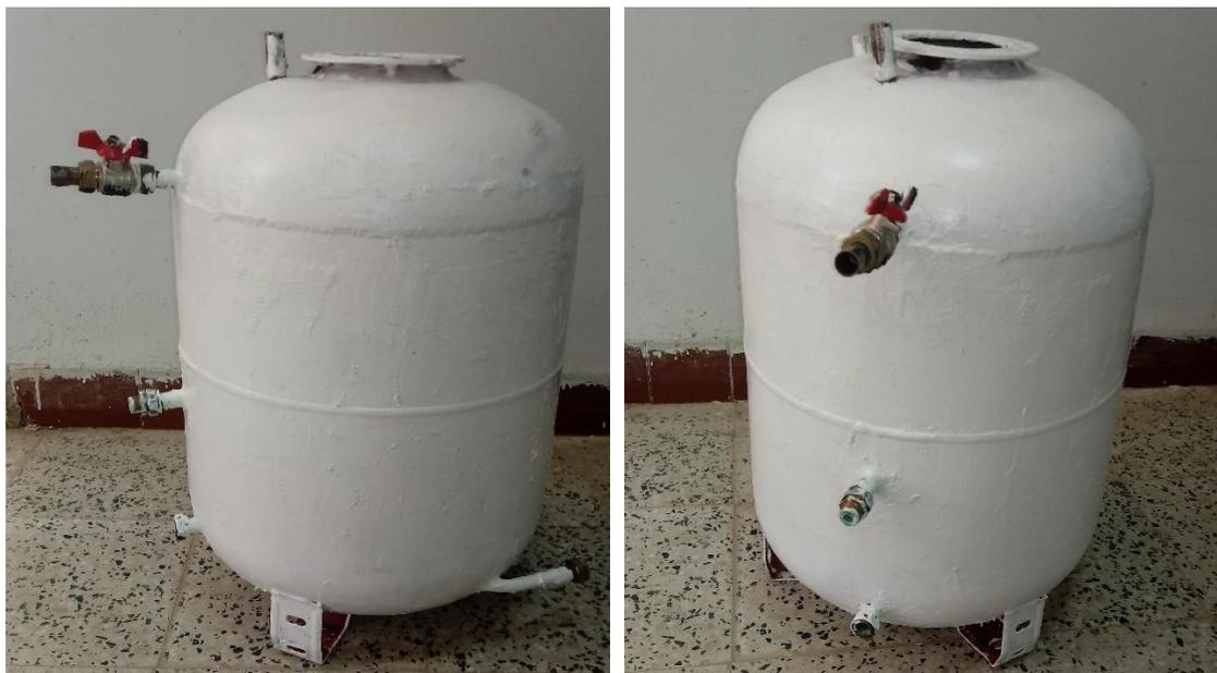
**Figure 2.12.** *La cuve de stockage*
