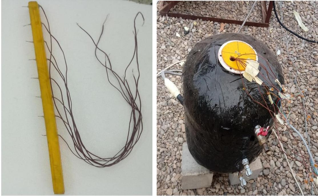
**Figure 3.2** Les thermocouples collés sur une tige pour immerger à différents niveaux dans la cuve de stockage.
