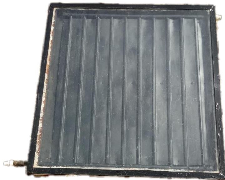
**Figure 2.11.** *La forme finale de capteur solaire.*
