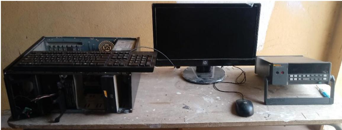
**Figure 3.5** L'acquisition connectée à un ordinateur pour stocker les mesures.
