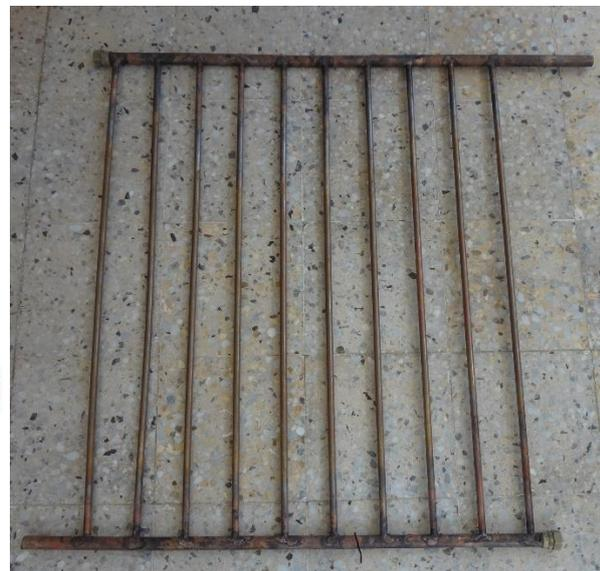
**Figure 2.6.** *Le collecteur du tube en forme radiateur*
