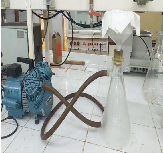
**Figure 3** : Lavage de la solution obtenu.
