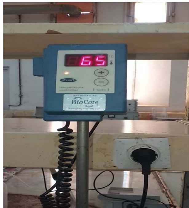
Figure 2 : le bain d'huile de la solution à 65°C
