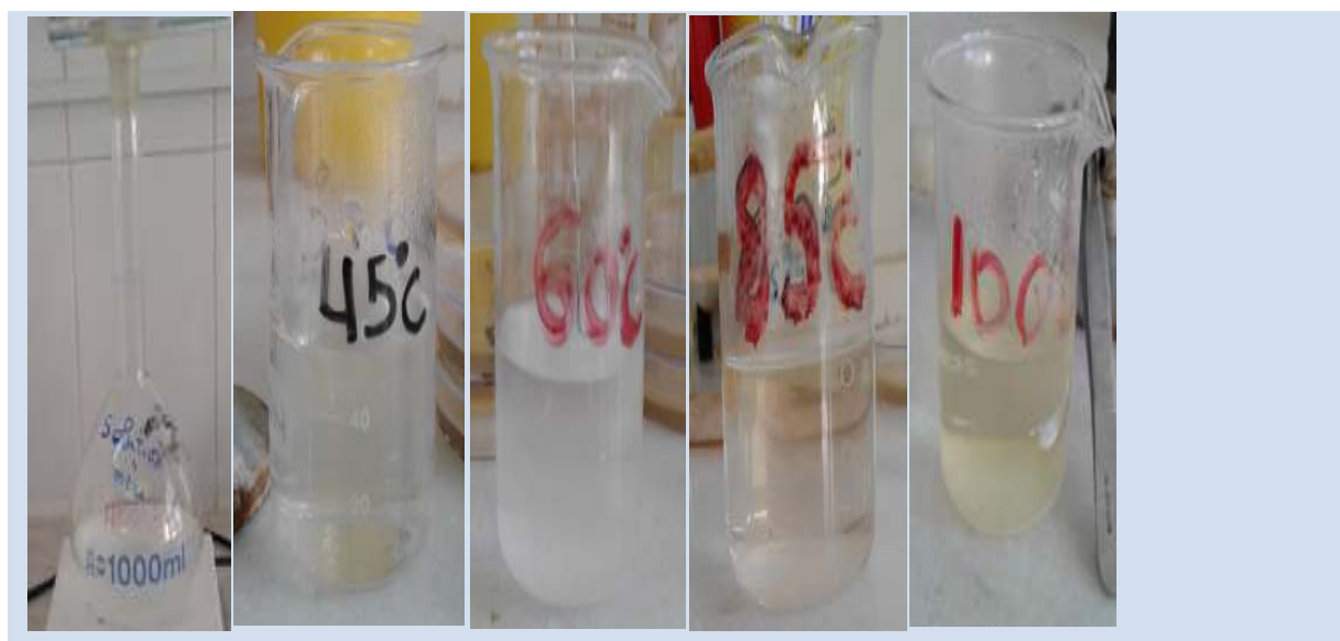
Figure 9: changement de couleur de la solution d'AMO TH après traitement thermique
