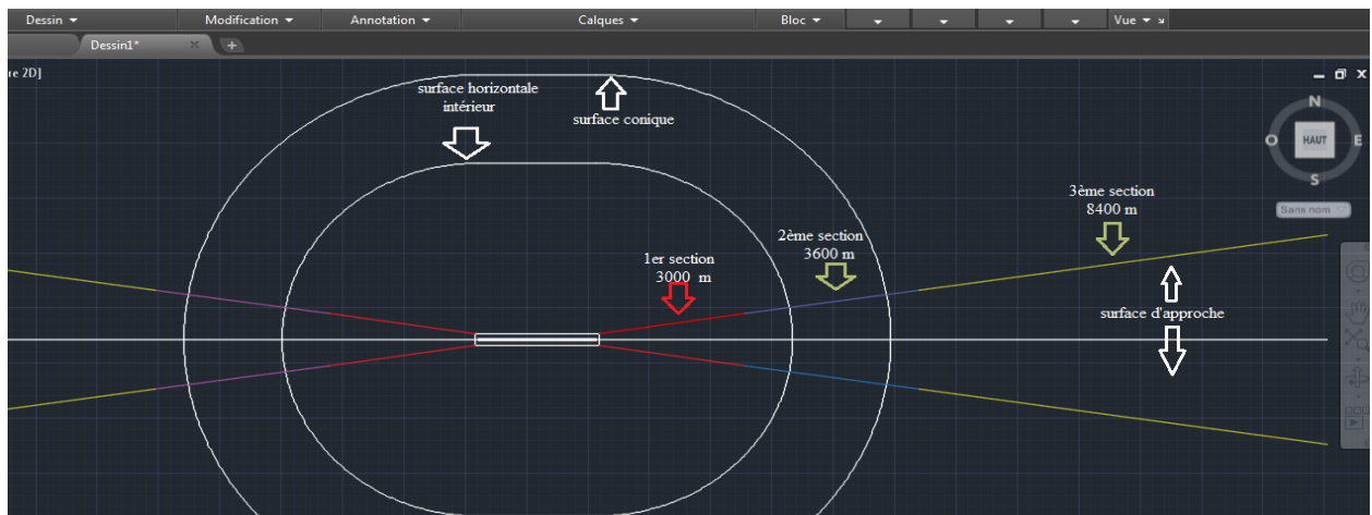
Figure 4. 8: Vue en plan des trois sections d'une surface d'approche.
