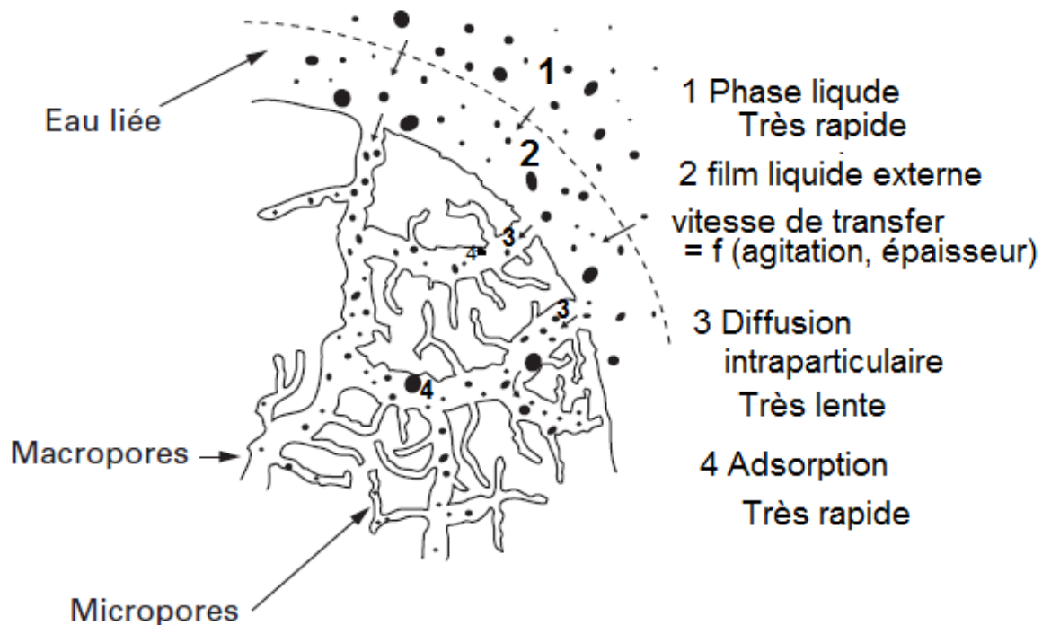
Figure I.2.1 : Domaine d'existence d'un soluté lors de l'adsorption d'un matériau microporeux[52].
