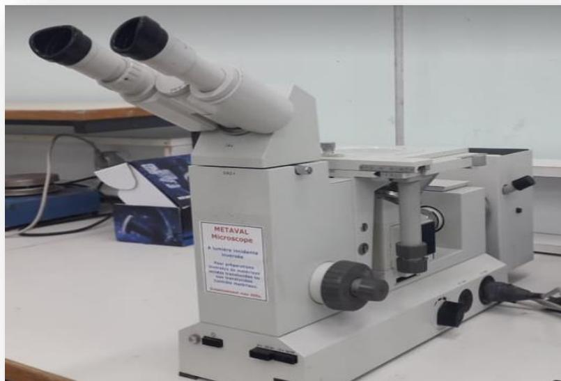
**Figure III.11** : Microscope METAVAL à lumière incidente inversée.
