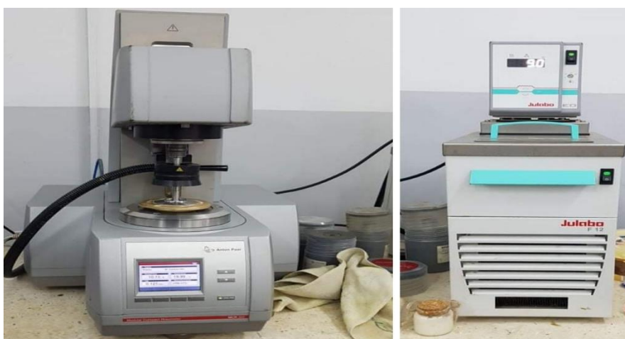
Figure III.22 : Rhéomètre Anton Paar Modulart Compact rheometer MCR302 et un thermostat
