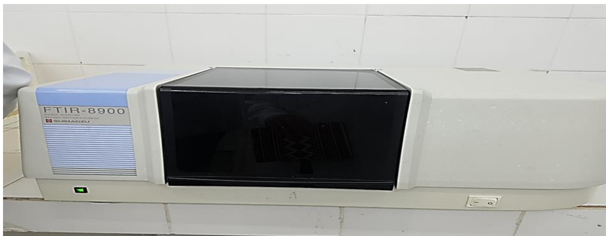
Figure III.12: Appareil spectroscopie Infra-Rouge à Transformée de Fourier « FTIR-8900- SHIMADZU »
