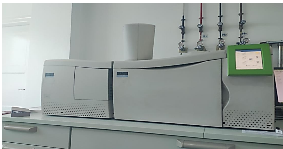
Figure III.13 : appareil GC/MS de modèle « CLARUS 500 -Perkin-Elmer »
