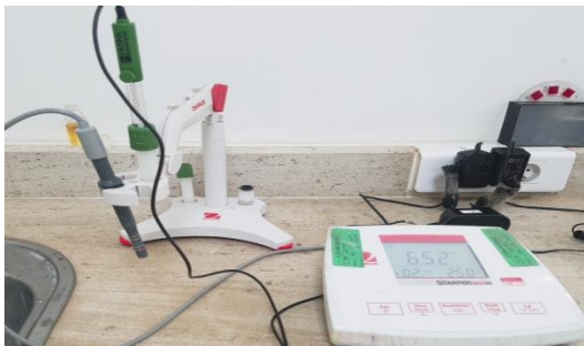
Figure III.10 : pH-mètre de type (OHAUS –STARTER 3100 M)
