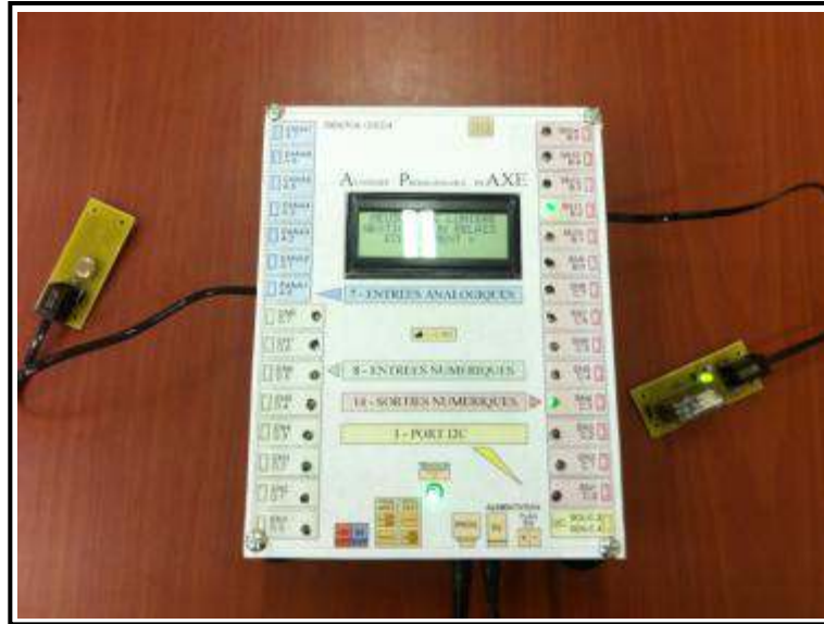
Figure 3. 31 : raccordement du relais et de la photorésistance avec l'automate
