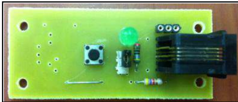
Figure 3. 10 : le circuit réalisé de l'état logique d'une touche
